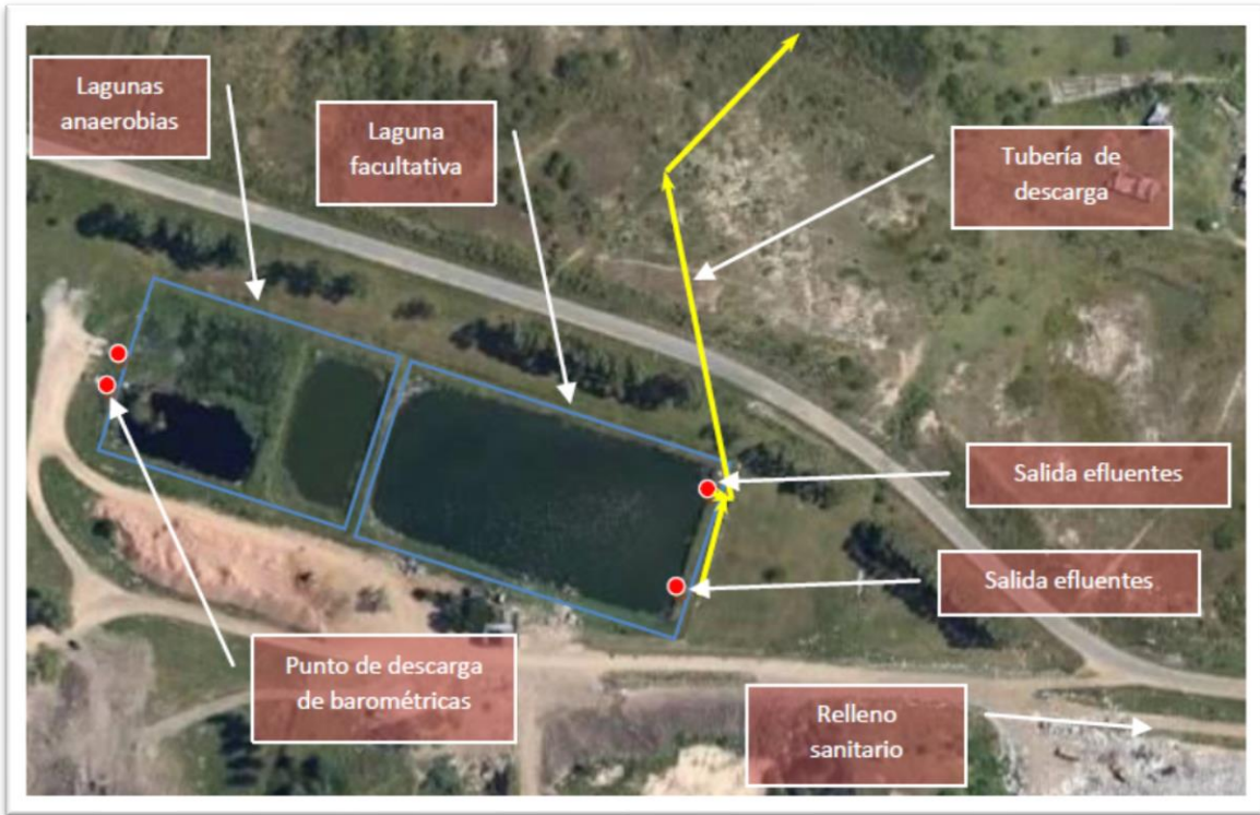
Esquema de sistemas de lagunas de tratamiento en operación
