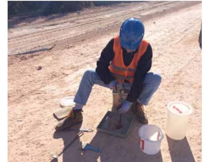
Ensayo de densidad por medio de cono de arena.
