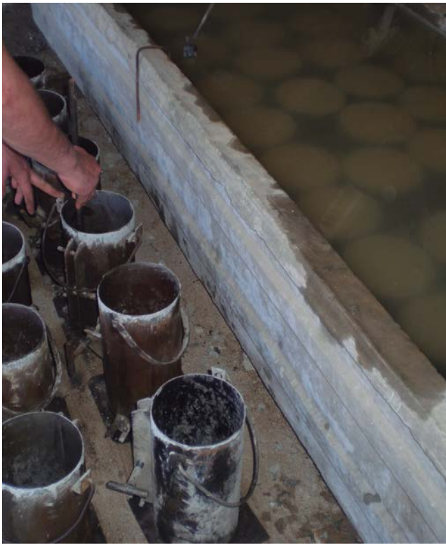
Probetas de hormigón para control de calidad.
