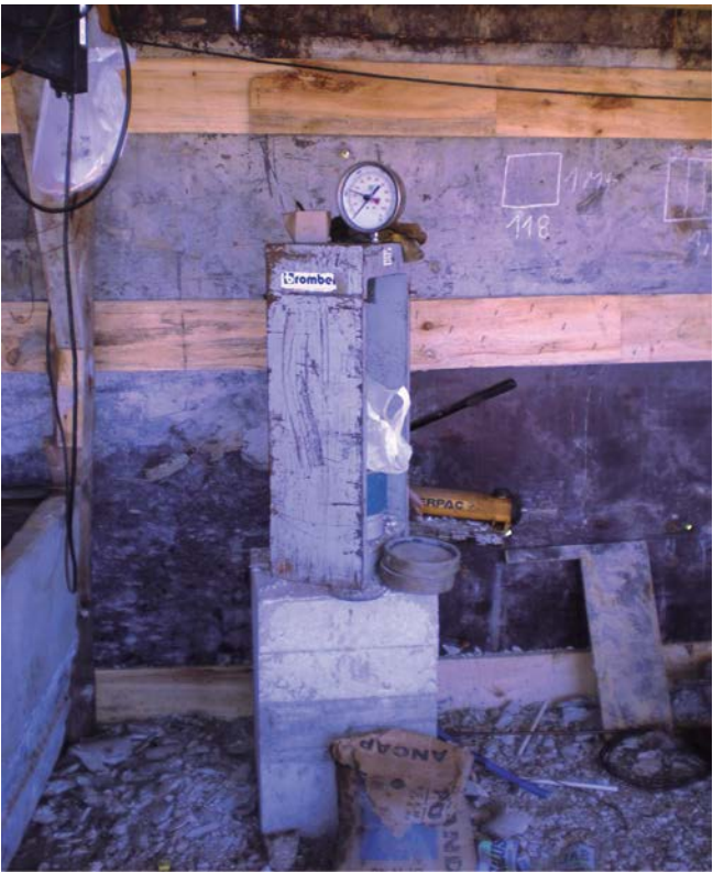
Prensa para rotura de probetas de hormigón (control de calidad).
