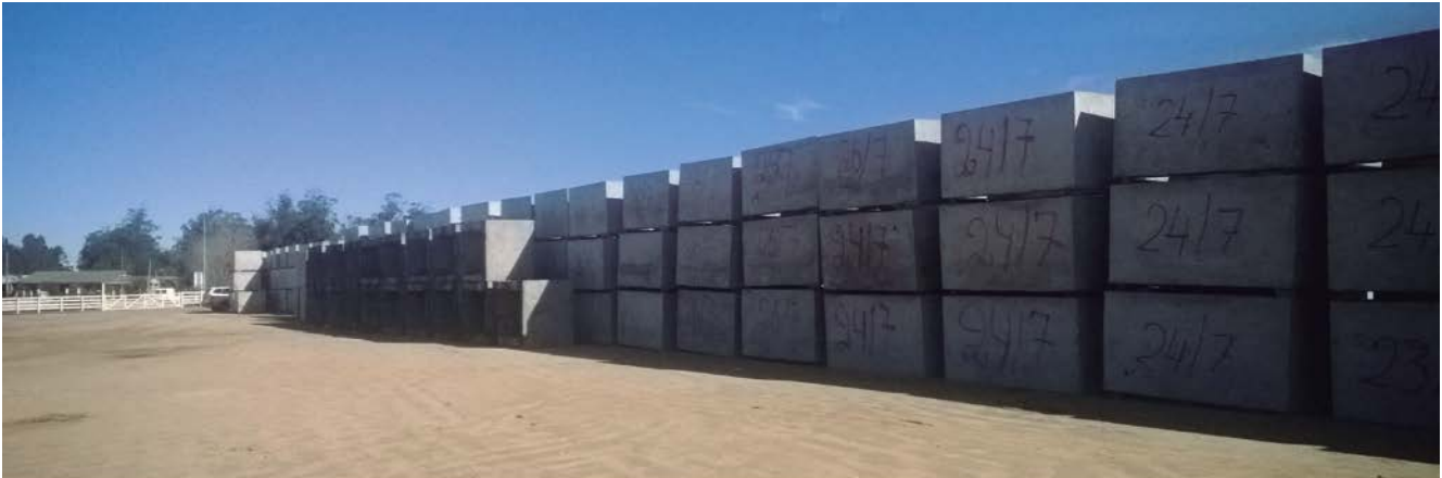
Piezas prefabricadas de hormigón armado para colector rectangular.
